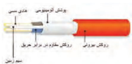
شکل ۱-۲۴ قسمت‌های مختلف یک کابل اعلام حریق
