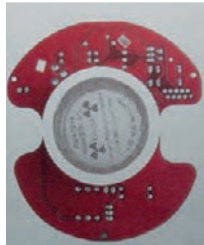
شکل ۱-۴ مدار داخلی یک آشکارساز یونیزاسیون با عنصر رادیواکتیو
